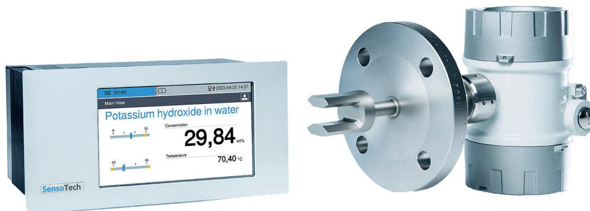
A medição ultrassônica do LiquiSonic baseia-se no método de medição por tempo, proporcionando alta precisão e estabilidade a longo prazo na determinação da concentração ou densidade de líquidos. A concentração ou densidade, que indica a qualidade do produto, é calculada a partir da velocidade do som. Além disso, é possível determinar outros parâmetros, como o teor Brix, o teor de sólidos, a massa seca ou a densidade da suspensão.
