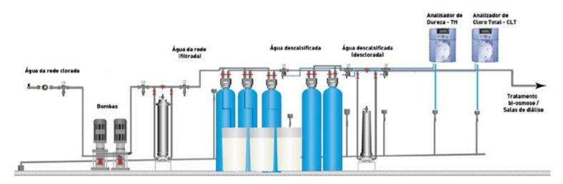
Tipo de implantação: Pré-tratamento — Descalsificador — Descloração Controlo de qualidade da água (TESTOMAT) — Dureza e Chloro Total antes de a Bi-Osmose / Salas de Diálise
